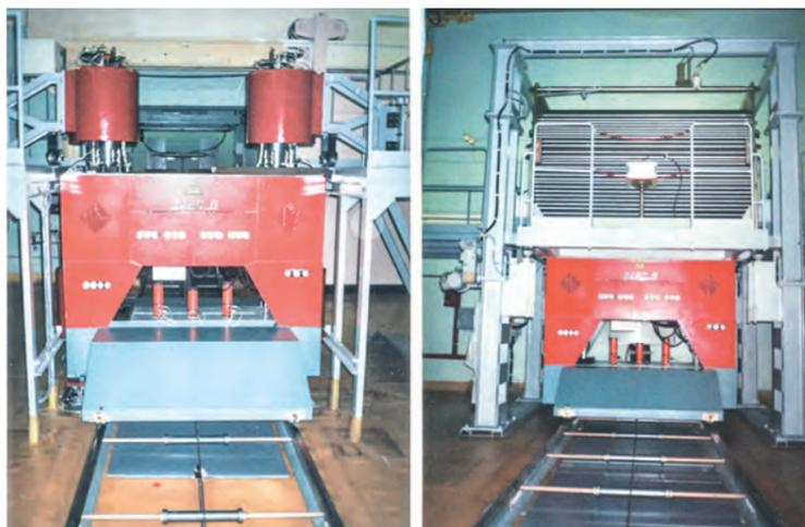
Слева — запальный реактор с двумя активными зонами «БАРС-60», справа — оптический квантовый усилитель с ядерной накачкой (ОКУЯН)
