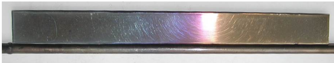
Рис. 1. Внешний вид образца после его экспозиции в потоке увлажненного аргона
